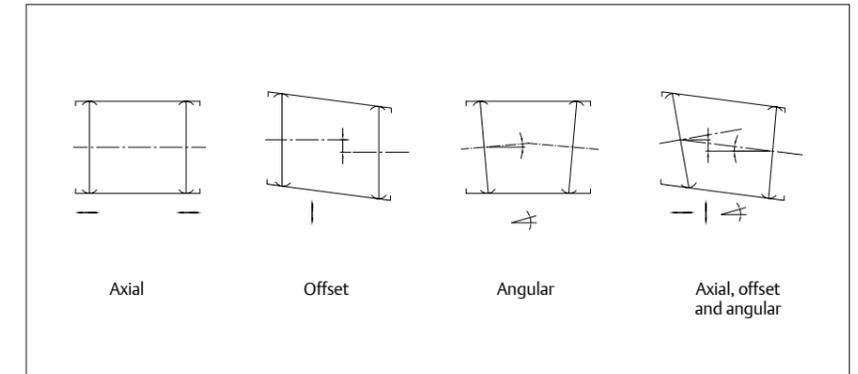
Fig n°3. Shaft misalignment
