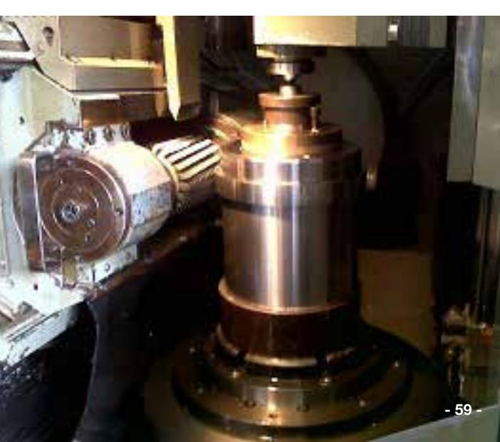
**21.9 GIUNTO A DENTI CON DISCO FRENO - GEAR COUPLING WITH BRAKE DISC**
